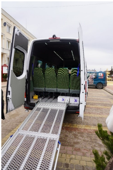
Rysunek 62 Pojazd marki Mercedes Benz Sprinter przystosowany do przewozu osób niepełnosprawnych – widok z tyłu z rozłożoną rampą podjazdową
