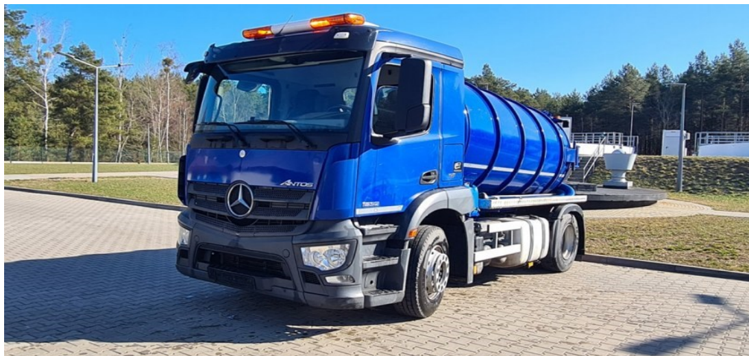
Rysunek 131 Samochód ciężarowy z beczką asenizacyjną o pojemności 9000 litrów, źródło: ZGKiM w Chorzelch
